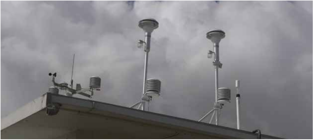
चित्र 1: सतत पर्यावरणीय वायू एवं मौसम मॉनीटरन स्टेशन Figure 1. Continuous ambient air and weather monitoring station
