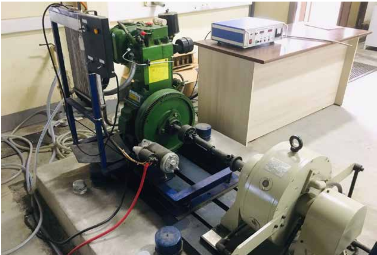
चित्र 1: आइसी इंजीन स्थापना एड्डी करेंट डाइनेमोमीटर के साथ Figure 1: IC engine setup with eddy current dynamometer
