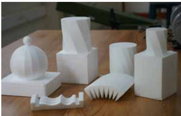
सी एन सी हॉट वायर कटर के साथ सैंपल कट्स Sample cuts with the CNC hot wire cutter
